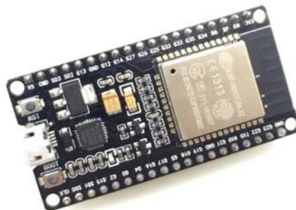
Figura 4.2. Imagen del microcontrolador ESP32.
